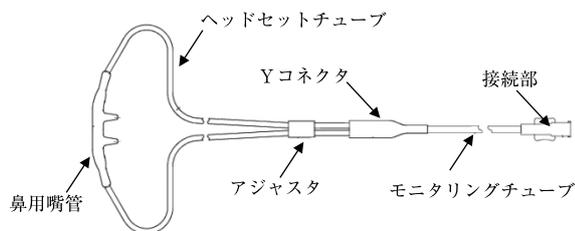
鼻用鼻管材質：ポリ塩化ビニル
