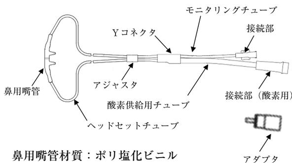
鼻用鼻管材質：ポリ塩化ビニル
